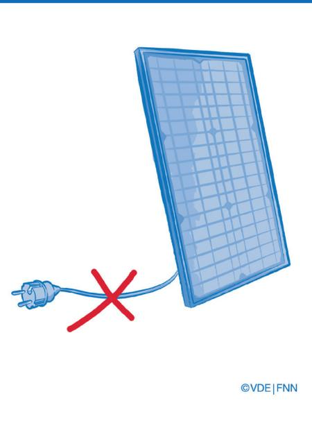
Daher fordert DIN VDE 0100-551 Erzeugungsanlagen immer auf der Versorgungsseite aller Schutzeinrichtungen der Endstromkreise anzuschließen.
